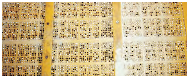
Gegossener PUR-Siebbelag mit über 50% Steckkorn. Die Durchsatzleistung ist durch den Verlust der offenen Siebfläche drastisch reduziert
