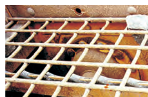
Verschleiß der Längstraversen beim Stahlsiebbelag
